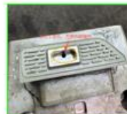
滑块后面对应处加工工艺孔，方便敲出镶件
