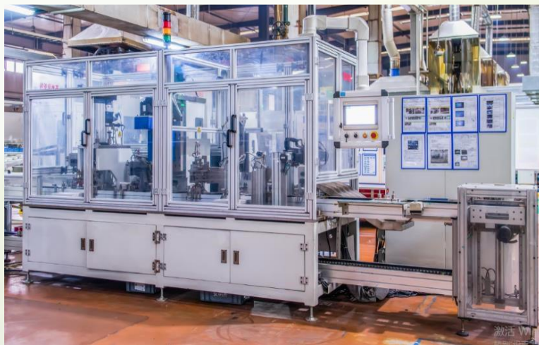
上支撑自动组装线
