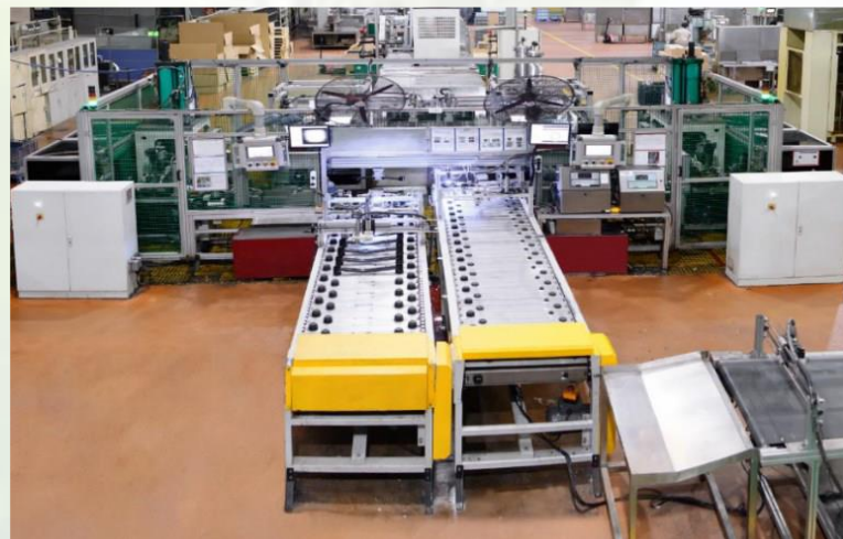
控制臂自动组装线
